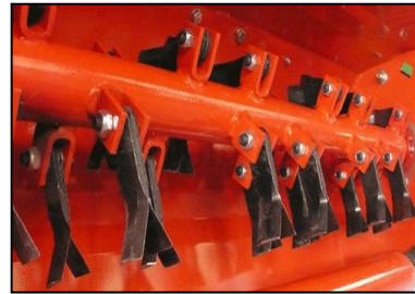
Şekil 3. Sap parçalama makinası ve düşey düzlemde dönü hareketi yapan sap parçalama makinasının Y tipi bıçakları (NUUMAN, 2018; Anonim, 2018)
